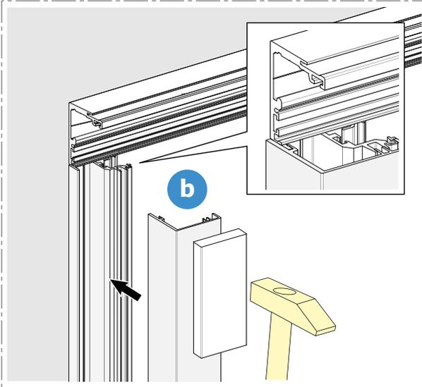
**ACHTUNG:** Für die Demontage der Blende einen Hebel aus Holz oder Kunststoff verwenden!
