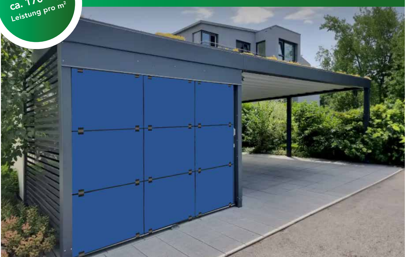
Übersicht der Fassadenverkleidung VSG 8 (2x4mm) Luxfine 4mm m. SD + PV Halbzellen + ESG 4mm m. SD, Kabelaustritt auf Glasrückseite
