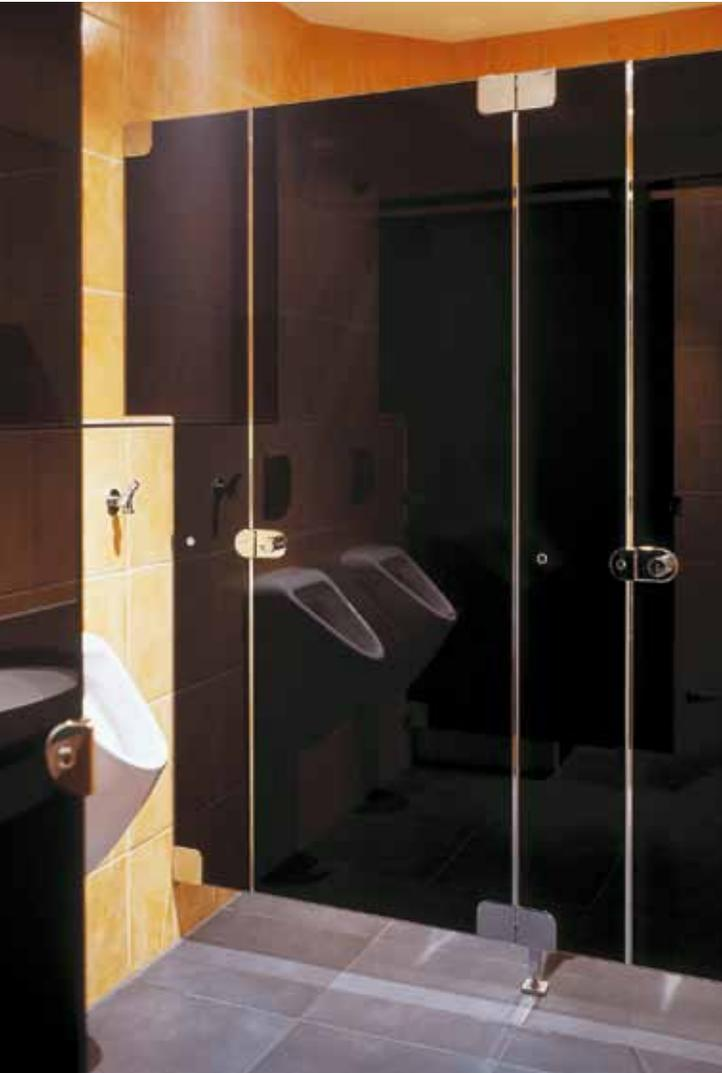
Trennwandsystem TWS 200 in ESG 10 mm. Der ganzflächig keramische Siebdruck bietet einen spannenden Kontrast zur farbigen Raumgestaltung. Beschläge glanzverchromt.
