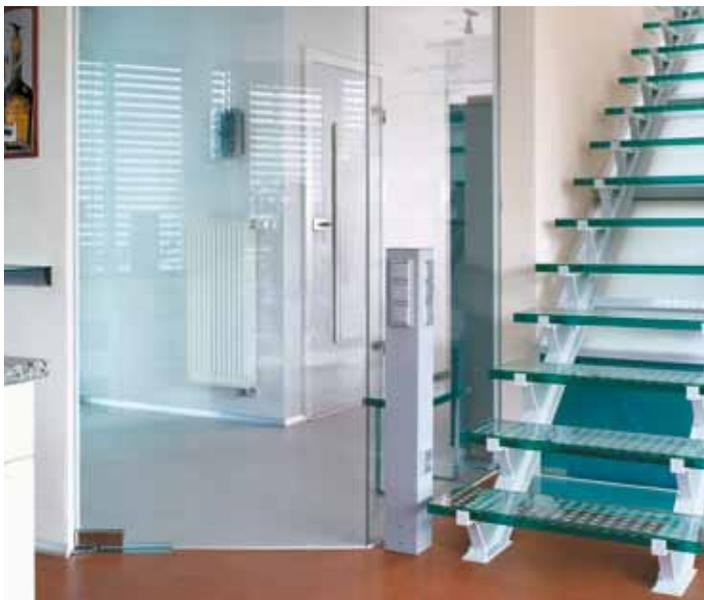
Ganzglas-Anlage mit raumhoher Tür und Seitenteil in ESG 10 mm. Die Positionierung des Seitenteils in einer 135°-Ausführung. Pendeltür mit Bodentürschließer. Polierte Kanten und edle Optik.
