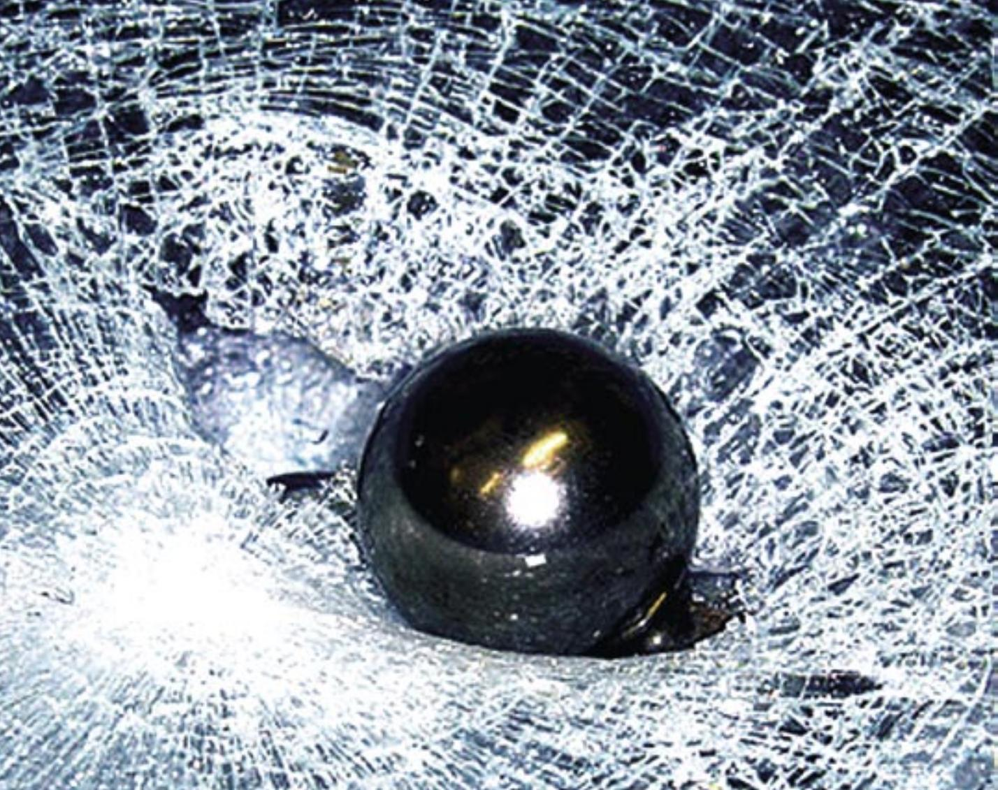
KUGELFALLPRÜFUNG MIT 4 KG SCHWERER STAHLKUGEL.
