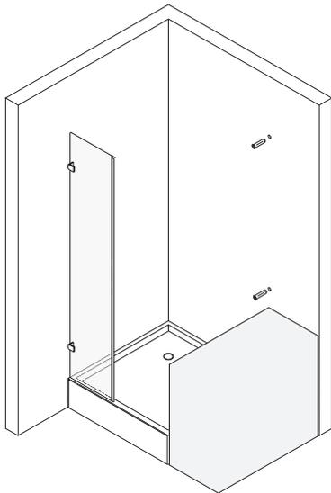
Befestigungslöcher kurzes Festteil bohren und dübeln
