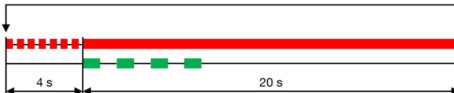
Im Beispiel wird der Fehlercode 4 angezeigt (Selbsttest – Oszillatorfehler).
