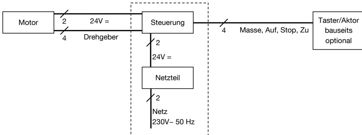
In der Regel wird Steuerung und Netzteil in zwei nebeneinanderliegenden Unterputz Dosen montiert.
