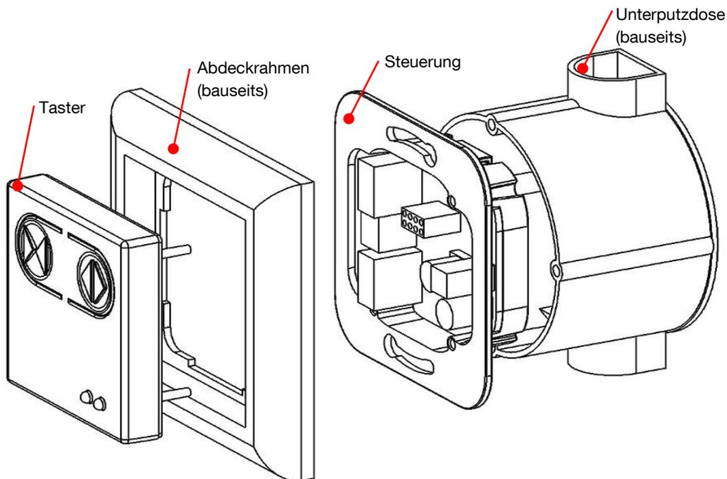
Abbildung 1 – schematische Ansicht: Montage Taster und Steuerung
